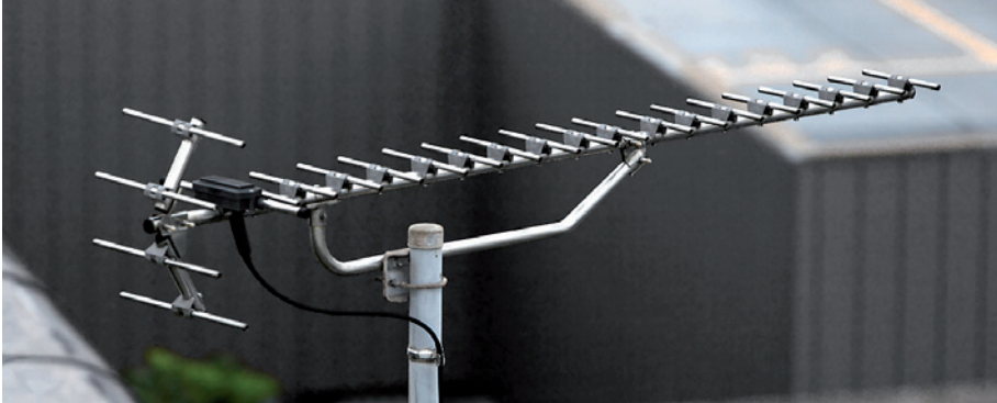
Abb-2: Typische Yagi Fernseh-Antenne für den UHF Bereich mit guter Richtwirkung. Die Längen der 22 Antennenstäbe sind auf etwa die halbe Wellenlänge abgestimmt. (Bild: Tennen-Gas, CC BY-SA 3.0)
