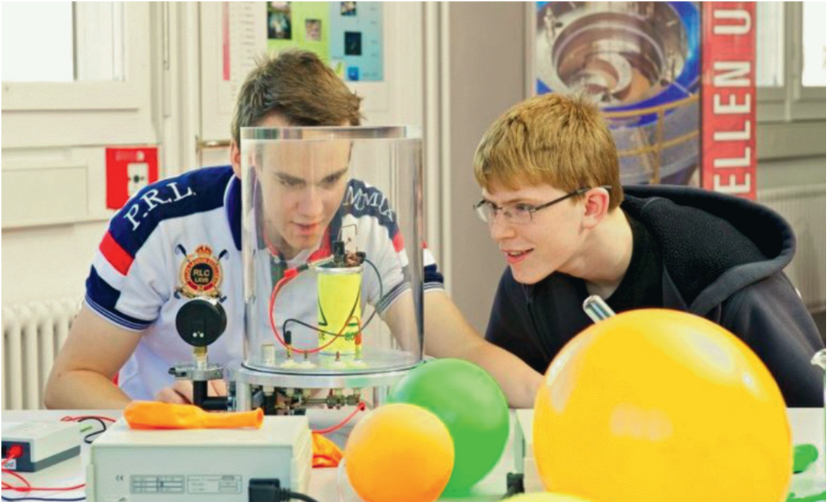
Abb. 2: iLab-Vakuumlabor am Paul Scherrer Institut (PSI). Funken im Vakuum mit Hilfe eines Auto-Zündtrafos. (Bild: PSI)
