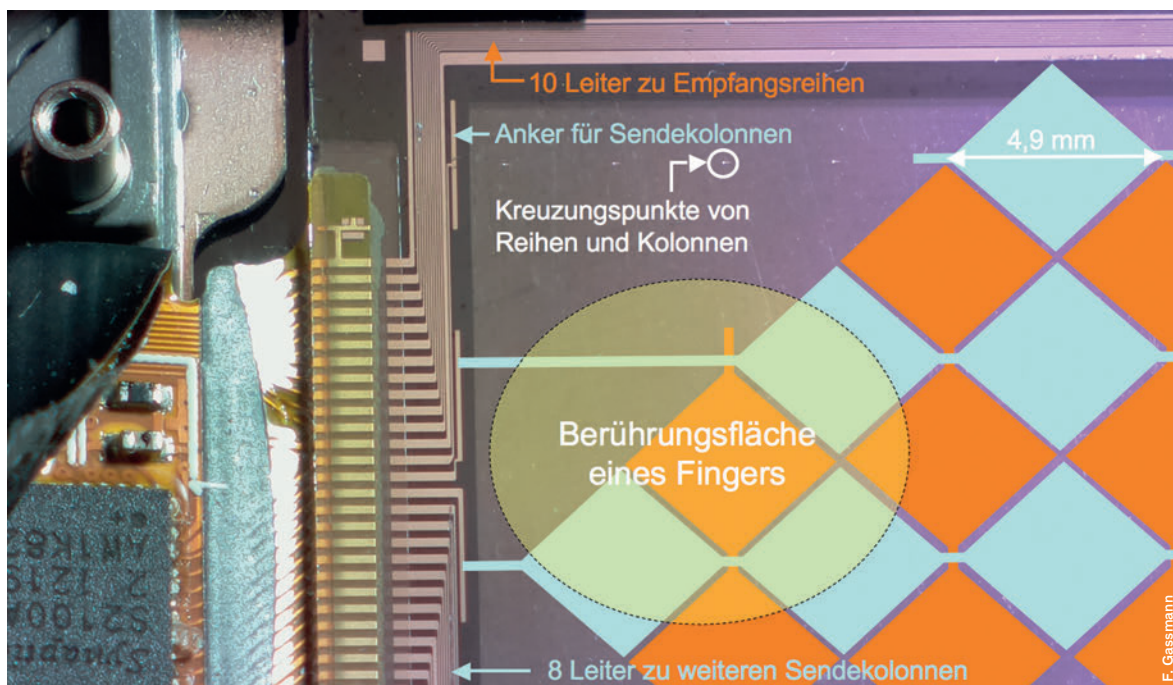
Abb. 3: Das berührungsempfindliche Feld besteht aus einer Glasscheibe, auf deren Aussenseite zwei gegeneinander isolierte transparente Leiterfolien aufgeklebt sind. Darüber ist eine isolierende Schutzschicht angebracht. Die blauen Sendeflächen (11 Kolonnen) und die orangefarbenen Empfangsflächen (18 Zeilen) geben einen Eindruck vom unsichtbaren Raster, dessen Form nicht festgestellt werden konnte. Der Ausschnitt zeigt nur 3 der 11 Anker, die für den Kontakt mit den blauen Flächen sorgen. 9 der 10 Leiterbahnen am oberen Bildrand führen zu analogen Ankerstrukturen für die orangefarbenen Flächen ausserhalb des Bildausschnittes. Die 10. Bahn führt zu 3 Bedienungselementen am unteren Rand des Handys. 9 weitere Leiterbahnen längs des gegenüberliegenden Randes des Tastfeldes (ausserhalb des Bildausschnittes) führen via Anker zu den abgebildeten orangefarbenen Flächen. Eine typische Berührungsfläche eines Fingers zeigt, dass mehrere Kolonnen und Reihen involviert werden: Die Software im links unten sichtbaren Chip der Firma Synaptics (San Jose, California, USA) bestimmt Millimeter-genau den Schwerpunkt der Berührung.
