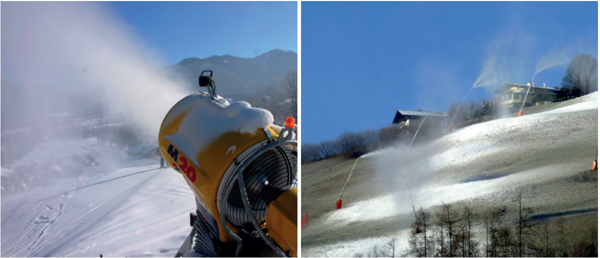
Abb. 1: Schneekanone (links) und Schneilanze (rechts) in Betrieb.
