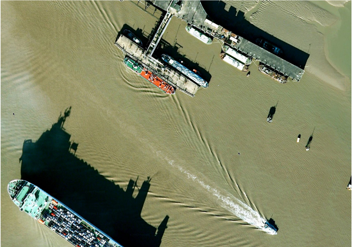
Satellitenbild der Themse mit Flussrichtung nach rechts unten bei der Queen Elizabeth II Bridge. Die Kielwasserwelle eines Pilotbootes (rechts unten) hat eine Wellenlänge von 3 bis 5 Metern und wird am Rumpf eines 60 Meter langen rot-grünen Schiffes reflektiert. Unterhalb des grünen Hecks sind Rhombus-förmige Überlagerungen (Interferenzen) kleinerer Wellen mit deren Reflexionen sichtbar.
