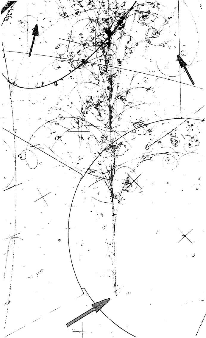
Fig. 2 Ein von einem hochenergetischen Neutrino in einer Blasenkammer am CERN erzeugtes Ereignis (dicker Pfeil). Dabei entstehende Gammaquanten produzieren in mehrfachem Wechsel einen Schauer von Elektronenpaaren (dünne Pfeile). Die Elektronen und ihre Antiteilchen (Positronen) werden durch ein Magnetfeld in entgegengesetzter Richtung aufgewickelt (Photo CERN).
