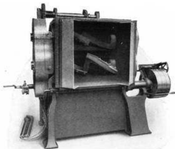
Abb.21. Zerfaserer für Alkalizellstoff bei der Viskoseseidenfabrikation, ausgeführt von Werner & Pfeiderer in Cannstatt
