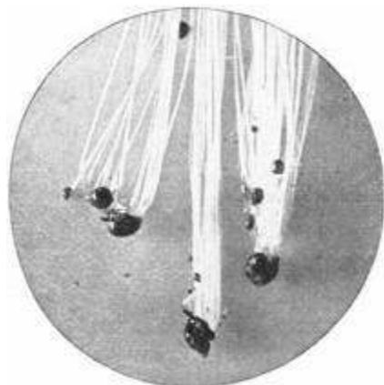
Abb. 36. Mikroskopisches Bild von angebrannter Azetatseide
