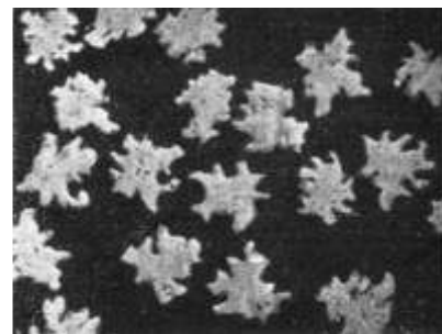
Abb. 48. Viskoseseide aus Baumwollabfällen. Derartige Kunstseiden zeigen einen sehr zackigen Querschnitt und scheinen dichter als Fabrikate aus Holzzellstoff. Der vorliegende Querschnitt deutet wegen seiner Form auf ein ziemlich stark saures Fällbad.
