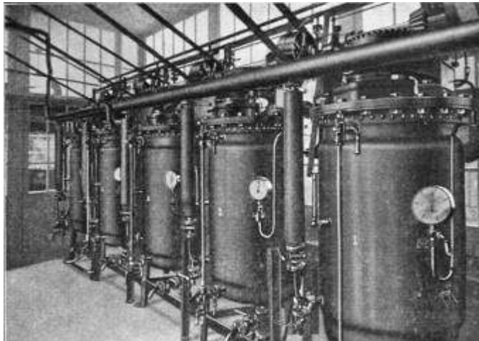
Abb. 16. Vorratsgefäße für die klarfiltrierte Spinnlösung.
