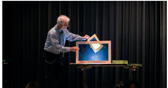
Transparentes Zellophan erscheint zwischen zwei gekreuzten Polarisatoren gelb. Glas hingegen ist unsichtbar, aber ein Papiertaschentuch erscheint leuchtend weiss.
