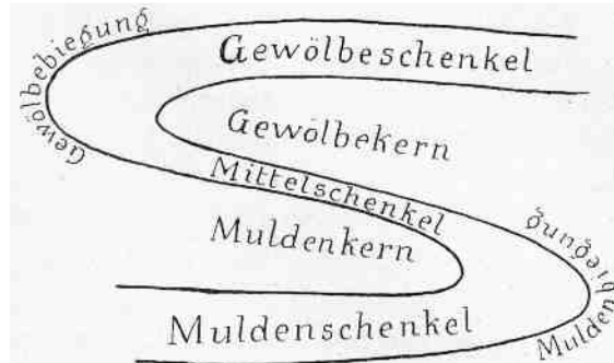
Fig. 5 Bezeichnung der Teile einer liegenden Falte (Querschnitt)
