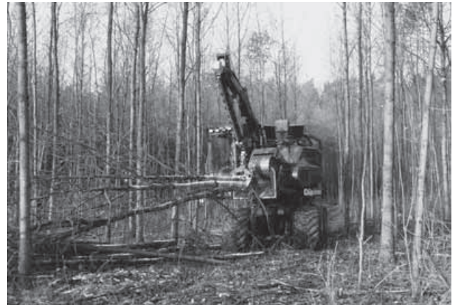
Abb. 1. Arbeitsverfahren «Hacken im Bestand»: mobiler Grosshacker mit schwenkbarem Einzug und kippbarem Container auf Forwarder-Fahrgestell. Das Verfahren kommt vor allem in jüngeren Beständen zum Einsatz. Die Arbeitsverfahren zur Erzeugung von Waldhackschnitzeln lassen sich nach dem Ort gliedern, an dem der Hackprozess stattfindet: Hacken im Bestand, an der Waldstrasse und an der Verbraucheranlage.
