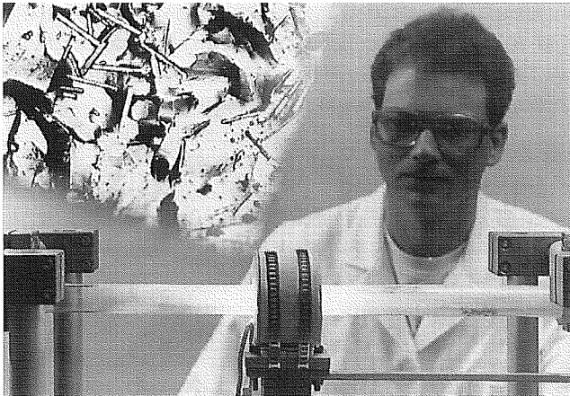
Ein Wissenschaftler am Institut für Nichtmetallische Werkstoffe der ETH Zürich überwacht den Schmelzprozess für die Herstellung eines Wismut-Kuprat-Supraleiters. Links oben im Bild ist eine mikroskopische Abbildung des komplexen polykristallinen Korngefüges des Werkstoffs eingebildet (Bild: H.R. Bramaz, Adliswil, für Schweiz. Nationalfonds, NFP/SPP-Pressestelle, Bern).
