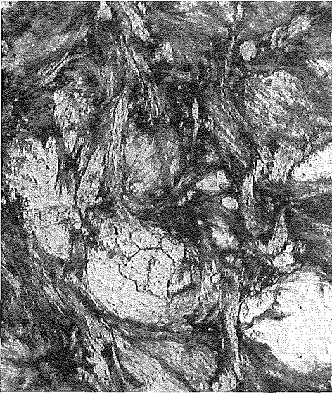
Fig. 1. Gefälte Faserbüschel von Sillimanit aus grösserem Einschluss, durchsetzt von Quarz (weiss) und reichlich Apatit (grau mit höherem Relief). Vergr. 30fach.
